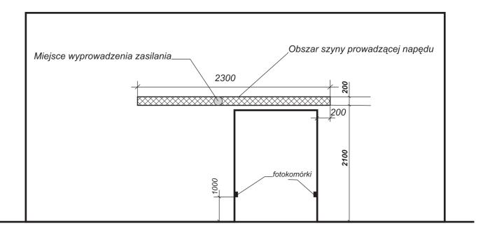
W obszarze mocowania napędu wyprowadzić zasilanie o parametrach:
